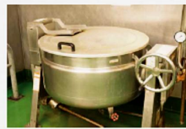
◎大量のモヤシなどもこの二重釜を使い、短時間でボイルする
