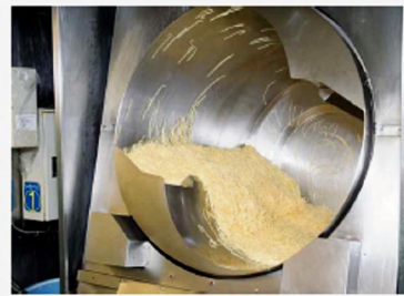
◎大量の麺類を一度で炒めることのできるロータリー◎焼そばは1回の工程で200食分が作られる
