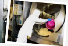
◎大量の麺類を一度で炒めることのできるロータリー◎焼そばは1回の工程で200食分が作られる
