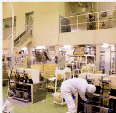
◎うどんのミキサー◎機械で延ばされた生地がカットされる
